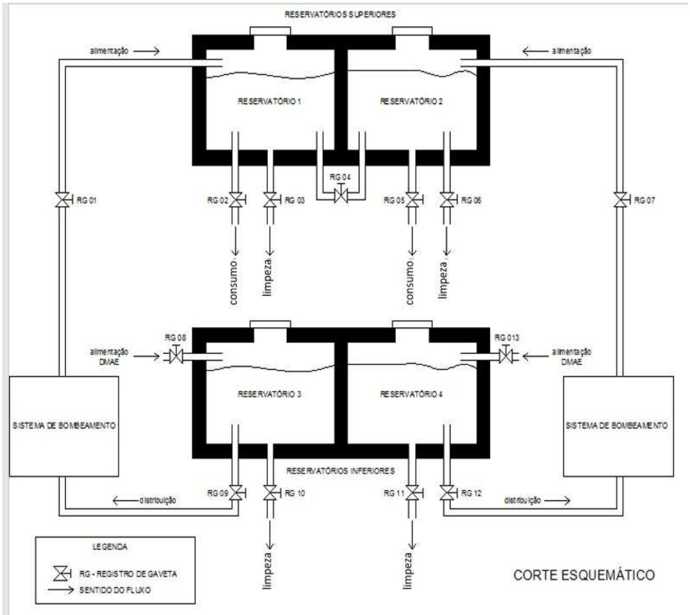
Para que seja possível realizar a limpeza semestral dos reservatórios de água do esquema acima, é necessário inicialmente esvaziar o reservatório 2. O abastecimento de água para os pontos de consumo deve ser mantido normalmente. Assinale a alternativa que apresenta, de forma correta, o procedimento que atende a esta situação.
