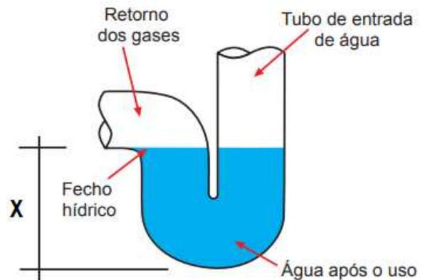
Fecho hídrico é o sifão responsável pela separação do esgoto primário do secundário, uma camada de água que bloqueia a passagem dos gases e de insetos. Essa camada de água deve ter, no mínimo, a altura indicada na imagem acima. Assinale a alternativa que apresenta o valor correto de X.
